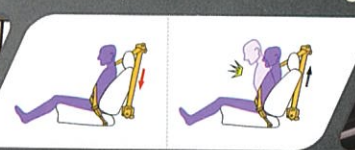
Front Seat Belt with Pretensioner & Force Limiter (Mulai dari Tipe X) Seat belt dirancang khusus untuk mengurangi potensi cedera saat air bag mengembang.
